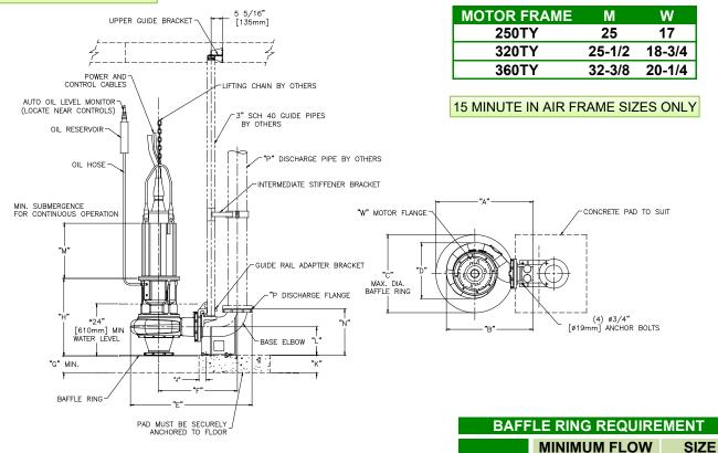
\*SSC8F ONLY 12" SUBMERGENCE REQUIRED BELOW 3300 GPM \*SSC10D ONLY 12" SUBMERGENCE REQUIRED BELOW 4800 GPM
